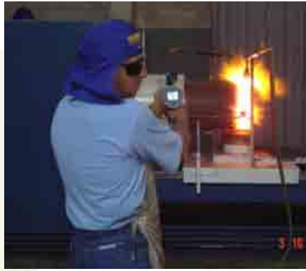
Controle da temperatura para início do processo de repuxo
