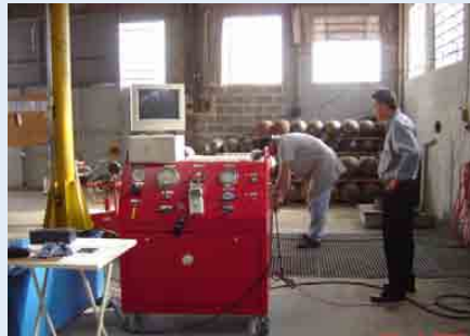
Início do ensaio de pressão cíclica
