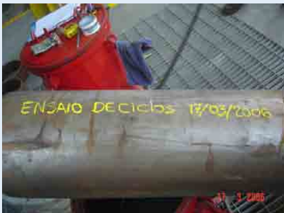
Preparação do corpo de prova para ensaio de pressão cíclica
