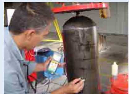
Verificação da espessura da parede após ensaio de pressão cíclica
