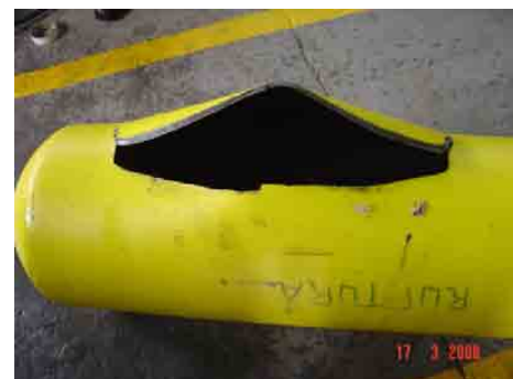
Ensaio de confirmação de ruptura em cilindro coletado no comércio
