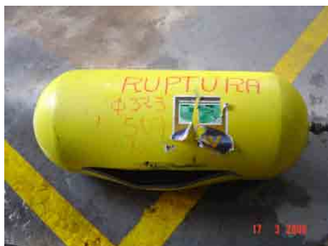
Ensaio de confirmação de ruptura em cilindro coletado no comércio
