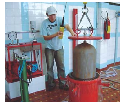
O cilindro é colocado dentro de uma camisa de água subterrânea onde é feito um ensaio hidrostático
