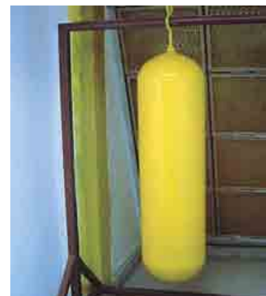
Se aprovado, o cilindro está apto a ser utilizado para os devidos fins. É pintado na cor amarela, conforme regulamentação, e selado
