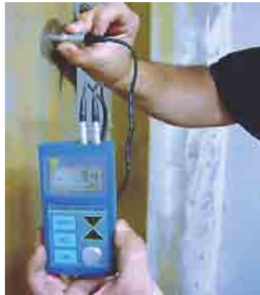
Sistema de ultra-som para medir a espessura das paredes do cilindro
